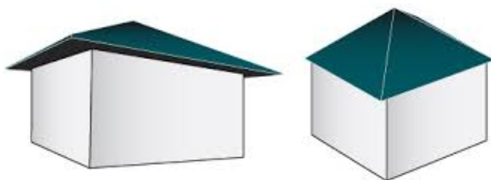
Toiture à 4 pans
